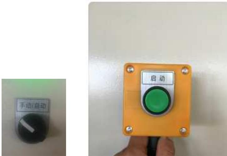
**手动方式：**当转环在原点时，缠绕圈数设定为 1-3 中任意一个数值时；按一下开关，转环运行，直至达到设定圈数，转环自动停止并断膜；
