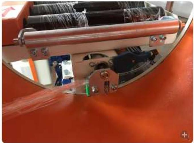
5.再按操作面板上的 **手动夹钳** 按钮，气缸缩回；
