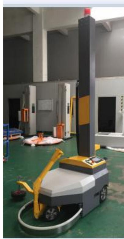
自走式缠绕机以 LLDPE 拉伸膜为主要材料，对体积大重量大整机或艺术产品进行包膜，防止货物发生散包和倒塌现象，对货物能起到防尘、防潮、防破损作用，广泛适用于印刷、造纸、化工、食品、物流等行业，包过膜的产品紧凑结实，外形美观。
